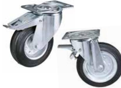
Ruota con nucleo in lamiera stampata e zincata, con supporto rotante a piastra e freno totale anteriore; anello in gomma piena nera a profilo trapezoidale; gruppo rotante realizzato con doppia corona di sfere. Codolo non incluso.
