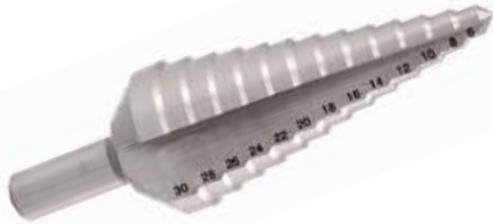
**Allargafori a gradino** per eseguire ed allargare a misura fori su lamiere in metallo, leghe leggere o laminati in plastica. Corpo in acciaio HSS fresato e rettificato, finitura lucida, parte terminale conica, punta del profilo affilato, marcatura laser dei diametri di riferimento. Non rivestito.
