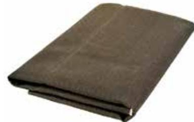
**Coperte di saldatura ALU BASIC**, in panno di fibra di vetro (a filamento), con rivestimento in PU su un lato. Leggere (460 gr/m<sup>2</sup>), adatte per utilizzo in verticale, per saldature leggere e lavorazioni a temperature non elevate. Resistenti alla temperatura fino a 550°C.
