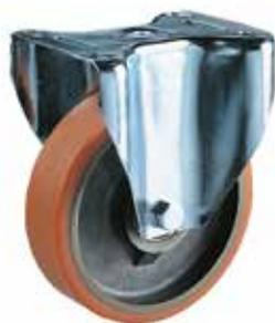
Ruota con nucleo in ghisa, con supporto fisso a piastra in lamiera stampata e zincata, serie media, rivestimento in poliuretano colato con durezza 92 ± 2 Shore A; gruppo rotante realizzato con doppia corona di sfere. Dado autobloccante al mozzo. Mozzo con cuscinetti a sfere.
