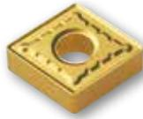
**Inserto di tornitura negativa CNMG...SM TT120/TT130;** rompitruciolo per sgrossature ad alte profondità di taglio e alti avanzamenti; adatto anche per lavorazioni con taglio interrotto; TT120 qualità specifica per la lavorazione di acciai e acciai bonificati, per taglio continuo medio ad alte velocità; TT130 qualità specifica per sgrossatura, taglio interrotto e medie lavorazioni di acciai e acciai inox.
