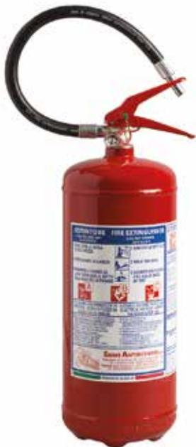
**Estintore a polvere 6 kg,** classe di fuoco 34° 233 BC, estinguento: polvere EPB 0351, temperatura di utilizzo da -30°C a +60°C, volume serbatoio 7,8 litri, tempo di scarica 15,5 secondi, serbatoio in lega di acciaio, costruito secondo la normativa UNI EN 3-7:2008, approvato da European Marine Directive MED 2014/90UE, SOLAS '74; certificato PED 2014/68/UE.
