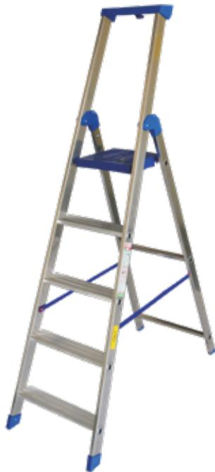
**Scala apribile CLIMB.** Scala leggera, maneggevole e comoda, con gradino espanso e ribordato per un utilizzo intensivo professionale. Cerniera antirottura. Vaschetta portaoggetti con fori porta attrezzi. Piattaforma automatica: 270x250mm; si blocca automaticamente durante l'utilizzo tramite gancio di sicurezza. Tacchi antidrucciolo. Gradini piani antidrucciolo: 80mm. Distanza tra i gradini: 280mm. Altezza parapetto: 600mm. Cinghie di sicurezza antiapertura maggiorate.
