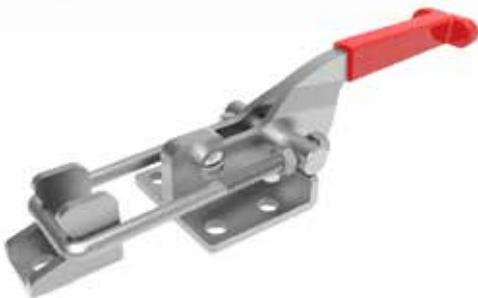
**Bloccaggio a tirante, base piatta, portata 320 kg**, Bloccaggio: a tirante; Base: piatta flangiata; Braccio: regolabile; Versione: orizzontale; Materiale: acciaio; Impugnatura: poliuretano rosso, resistente a oli, grassi, agenti chimici; Peso: 225 gr.
