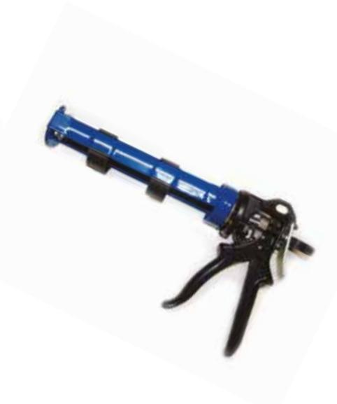
Pistola sigillante a stelo professionale, con asta di spinta da 8 mm, sistema di spinta S.T.D., fondello rinforzato in acciaio e sistema "anti-goccia"; specifica per tutti i tipi di sigillanti e siliconi in cartuccia; per uso professionale.
