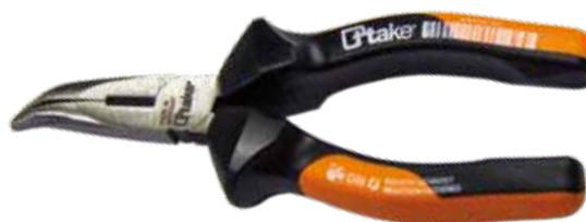
Pinza per meccanica, a becchi mezzotondi piegati e tronchese, manici ergonomici, testa pulita, taglienti durezza 60 HRC, becchi mezzotondi piegati a 40°, lunghi, con interni zigrinati e tronchese, DIN ISO 5745, per lavori di precisione e taglio di fili con ottima visuale dello spazio di lavoro; disponibile nelle versioni con manici rivestiti in materiale bicomponente e con manici isolati 1000V VDE.
