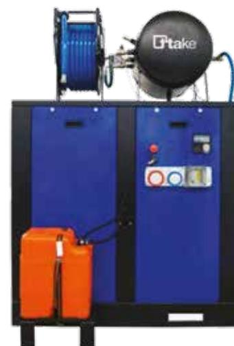
Macchina MULTIENERGY, dotata di potente motore Diesel, 17 HP con raffreddamento a liquido. Costruita su un solido telaio schermato da pannelli fonoassorbenti che riducono il rumore fino a 78 dB (A). Compressore: 2 stadi, 2 cilindri. Serbatoio aria: 80 litri. Aria erogata: 1000 l/min. Pressione max: 12 bar. Motore: Lombardini-Kohler. Generatore monofase/trifase: 220V / 380V - 6.5kVA / 9.0 kVA. Avviamento elettrico. Dotata di stabilizzatore AVR. Dimensioni: 1160x647x1620 mm.
