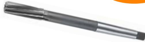
Alesatori in HSS-Co TA1204, DIN 208, attacco conico, tolleranza H7, elica sinistra a 5° adatti all'alesatura di tutti i tipi di materiale, a basse velocità di taglio
