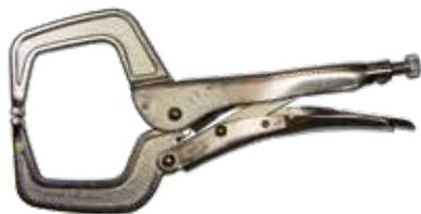
**Pinza regolabile autobloccante con ganasce a collo di cigno**, esecuzione nichelata, presa sicura di materiale piatto e sagomato, vite di regolazione e leva interna di rilascio a scatto, DIN ISO 5743, per il serraggio di pezzi e profili voluminosi con spessore fino a 40mm.
