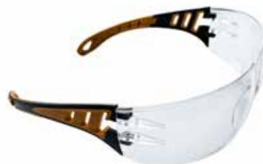
**Occhiali EVO-SUN con lenti in policarbonato grigio, PC controimpatto, con trattamento antiappannante e antigraffio, classe ottica 1.** Montatura confortevole, estremamente avvolgente ed ergonomica. Astine in materiale bicomponente. Grado di protezione: F. Resistenza alla temperatura: T (da -5° a +55°). Codice filtro: 5 - 3,1. Regolamento: UE 2016/425. Certificazione: CE EN 166 - EN 172.
