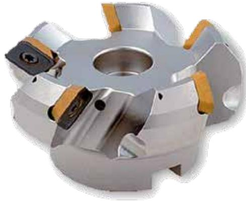
Fresa a manico superpositiva TA4513, per spianature a 45°, con fori di refrigerazione; universale per la lavorazione di tutti i tipi di materiali; adatta all'utilizzo degli inserti SE.. 13T3..
