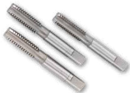
Serie di 3 pz. maschi a mano in HSS TA1600, generici, per tutti i tipi di materiale, filettatura MA metrica, passo grosso, tolleranza 6H
