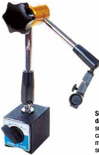
Supporto portacomparatore snodato magnetico. Aste totalmente snodabili e orientabili con bloccaggio centralizzato e regolazione micrometrica. Base magnetica con superfici di appoggio piana e a "V" rettificata. Attacco comparatore Ø 8 mm.
