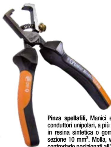
Pinza spellafili, Manici ergonomici, Testa pulita, per conduttori unipolari, a più fili, a fili sottili con isolamento in resina sintetica o gomma. Ø massimo cavi 5mm, sezione 10 mm<sup>2</sup>. Molla, vite di regolazione zigrinata e controdado posizionati all'interno.
