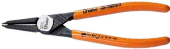
Pinza per anelli di sicurezza interni, manici rivestiti in resina sintetica (pvc), testa bonderizzata nera, per il montaggio di anelli di sicurezza interni (DIN 471 e DIN 983) per fori da Ø 8 – 140mm, punte diritte resistenti antiscivolo, DIN ISO 5256 C.
