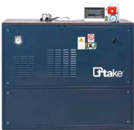
Macchina MULTIENERGY, con solida struttura fonoisolante, motorizzata Diesel, 10.2 HP. Compressore: 2 stadi, 2 cilindri. Serbatoio aria: 100 litri. Aria erogata: 900 l/min. Pressione max: 10-12 bar. Motore: Hatz. Generatore monofase/trifase: 220V / 380V - 6.5kVA / 7.5 kVA. Avviamento elettrico. Dotata di stabilizzatore AVR. Dimensioni: 1270x700x1050 mm.
