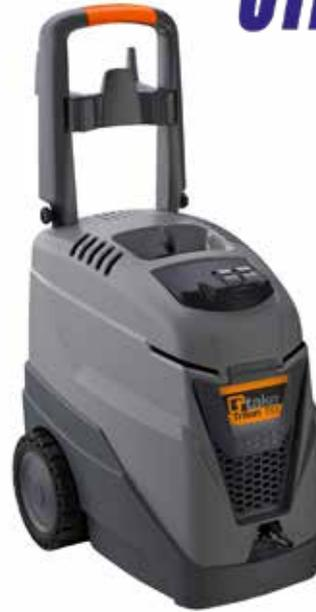
**Idropulitrice OCEANO 150** Ad acqua calda, con elettropompa a 3 pistoni assiali disposta in orizzontale con pompa in basso, costruita interamente in metallo e testata in ottone. Dotata di dispositivi "easy-start" e "total-stop"; protezione amperometrica del motore, serbatoio gasolio e detergente integrati, manometro pressione, aspirazione acqua diretta con detergente in bassa pressione, termostato per regolazione temperatura, partenza ritardata del bruciatore. Per uso semiprofessionale.
