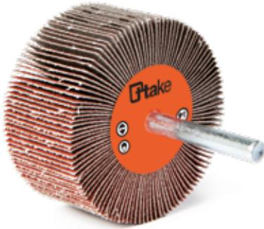
Ruote lamellari in tela abrasiva al corindone con gambo, per operazioni di smerigliatura e finitura interna ed esterna di piccoli pezzi meccanici in acciaio al carbonio, acciaio inossidabile e metalli non ferrosi; ideali anche per la pulizia e la finitura di stampi.
