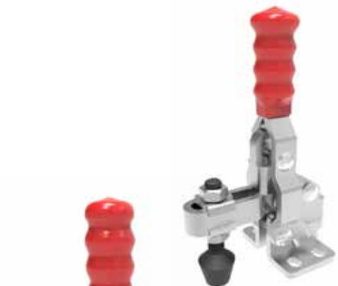
**Bloccaggio verticale, base piatta, portata 90 kg,** Bloccaggio: verticale; Base: piatta flangiata; Braccio: regolabile; Materiale: acciaio; Impugnatura: poliuretano rosso, resistente a oli, grassi, agenti chimici; Peso: 170 gr.
