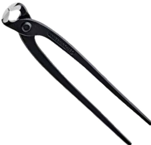
**Tenaglia per ferraioli e cementisti.** Utilizzabile anche per legare e tagliare fili di fermo per armature. Per torcere e tagliare il filo dal rullo in una sola operazione. Taglienti ulteriormente temperati, durezza dei taglienti 61 HRC. Manici senza rivestimento.
