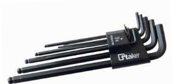
**5028 KT09** Serie chiavi maschio esagonale piegate, con testa sferica, Acciaio speciale al Cromo Vanadio - Esecuzione brunita - Testa sferica, per viti con esagono incassato, consentono operazioni con inclinazioni fino a 25° rispetto all'asse della vite, supporto in plastica.
