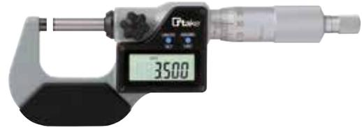
Micrometro digitale IP65, resistente alla polvere e all'acqua. Misurazione assoluta/incrementale in qualunque posizione. Tamburo graduato cromato opaco. Frizione sensitiva. Nottolino di bloccaggio. Arco con guanciali termoisolanti. Stelo Ø 6,5 mm. Superfici di contatto riportate in metallo duro. Tasti: on/off – zero/abs – mm/pollici – unit. Risoluzione 0,001.
