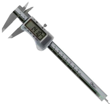
Calibro a corsoio digitale con cassa in metallo, becchi e punte con inserti in metallo duro. Bloccaggio a vite. Accensione e spegnimento con pulsante. Conversione mm/pollici; risoluzione 0,01.
