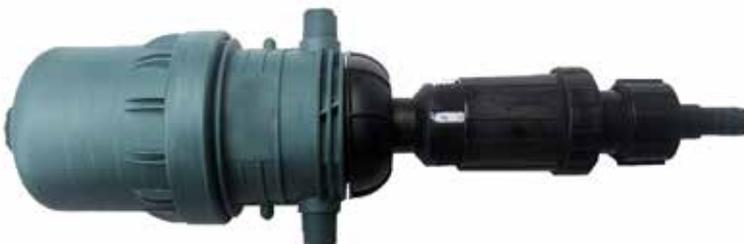
**Miscelatore volumetrico automatico per fluidi di processo.** Garantisce una corretta miscelazione di lubrificanti e liquidi detergenti; adatto a tutte le lavorazioni meccaniche di asportazione truciolo con centri di lavoro, torni CNC, ecc. Valori di dosaggio: da 1% a 10%.
