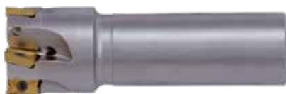
Fresa per spallamento retto a 90° TA9010 con attacco Weldon, con fori di refrigerazione; adatta all'utilizzo di inserti APKT 1003,...
