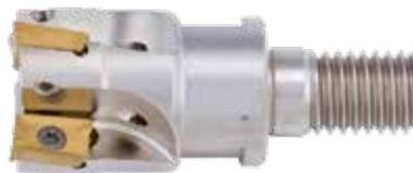
Fresa per spallamento retto a 90° TA9010 con attacco filettato, con fori di refrigerazione; adatta all'utilizzo di inserti APKT 1003,...
