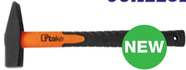
5077 Martello manici fibra per meccanici. Manico in bi-componente antiscivolo, con anima interna in fibra di vetro per una maggiore rigidità. Testa in acciaio C45 temprato a induzione con verniciatura a polvere epossidica.
