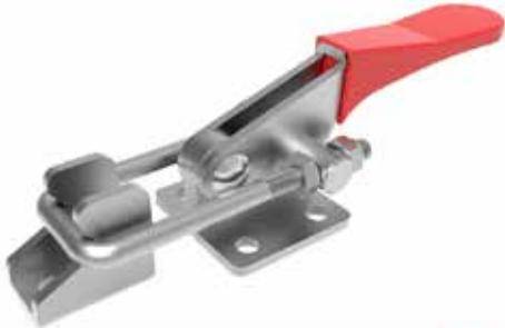
**Bloccaggio a tirante, base piatta, portata 170 kg**, Bloccaggio: a tirante; Base: piatta flangiata; Braccio: regolabile; Versione: orizzontale; Materiale: acciaio; Impugnatura: poliuretano rosso, resistente a oli, grassi, agenti chimici; Peso: 70 gr.
