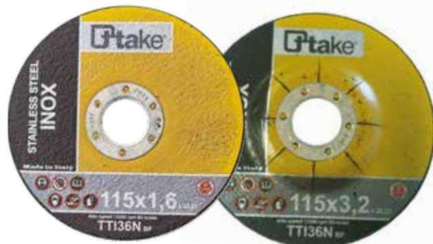
**Mole abrasive piane e a centro depresso da taglio e sbavo, per ACCIAIO:** Adatte al taglio di acciai normali, medio legati e di ghise acciaiose, e allo sbavo di acciai con superficie di molatura estesa e lavorazione di ghise grigie. Bassa asportazione di materiale. Taglio di sezioni medio-grosse con smerigliatrici potenti (2400W), sezioni medio-piccole con smerigliatrici di bassa potenza (1800-2000W). Alta velocità di taglio e buona tenuta del disco.
