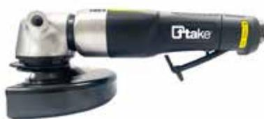
Smerigliatrice pneumatica angolare a disco. Velocità libera: 12.000 giri/min. Diametro disco: 125 mm. Filettatura mandrino: M14 x 2,0. Attacco aria: 1/4" NPT. Ø interno tubo aria: 10 mm. Consumo aria: 105 l/min. Lunghezza totale: 253 mm. Peso: 1,6 kg. Rumorosità: 86 dBA.
