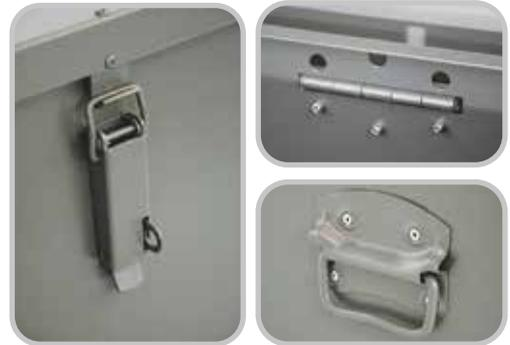
Baule in acciaio zincato, spessore 1,5 mm, verniciato esteriormente a polveri epossidiche. Dotato di due ampie maniglie laterali in acciaio zincato, due chiusure di sicurezza predisposte per lucchetto e cerniere autobloccanti a 90°. Disponibile in tre diverse dimensioni.
