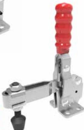
**Bloccaggio verticale, base piatta, portata 230 kg,** Bloccaggio: verticale; Base: piatta flangiata; Braccio: regolabile; Materiale: acciaio; Impugnatura: poliuretano rosso, resistente a oli, grassi, agenti chimici; Peso: 355 gr.
