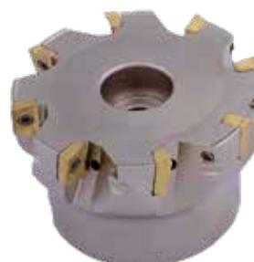
Fresa per spallamento retto a 90° TA9010 con attacco a manicotto, con fori di refrigerazione; adatta all'utilizzo di inserti APKT 1003,...
