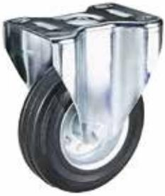
Ruota con nucleo in lamiera stampata e zincata, con supporto fisso a piastra; anello in gomma piena nera a profilo trapezoidale. Codolo non incluso.
