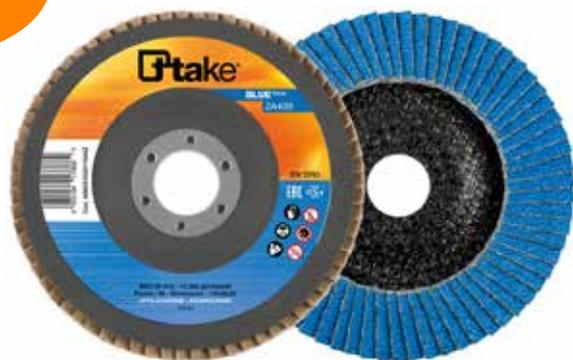
**Disco lamellare LARGE zirconio AB6500**, piano, a lamella singola, in tela abrasiva allo zirconio e supporto in fibra di vetro. Grande potere di asportazione, unito ad una lunga durata nel tempo. Autoravvivante (consumo progressivo della lamella), garantisce il massimo rendimento di asportazione. Ideale per utilizzo su acciai altamente legati, acciai inox, acciai non legati e acciai a bassa lega.
