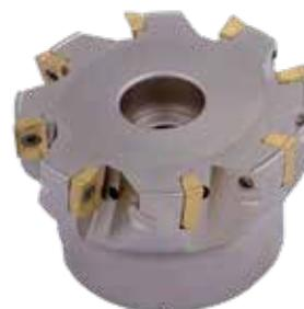
Fresa per spallamento retto a 90° TA9016 con attacco a manico, con fori di refrigerazione; adatta all'utilizzo di inserti APKT 1604...
