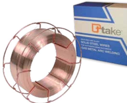
**Filo pieno ramato** per la saldatura sotto protezione di gas CO<sub>2</sub> o miscela di Ar/CO<sub>2</sub> di acciai al carbonio, acciai al manganese e similari, anche a grana fine. Caratterizzato da elevato rendimento, buona operatività anche in posizione, bassa emissione di spruzzi, ridotta quantità di silicati ed eccellente estetica del cordone.
