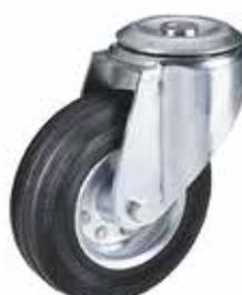
Ruota con nucleo in lamiera stampata e zincata, con supporto rotante a foro passante; anello in gomma piena nera a profilo trapezoidale; gruppo rotante realizzato con doppia corona di sfere. Codolo non incluso.
