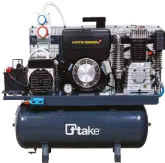
Macchina MULTIENERGY, motorizzata Diesel, 10.2 HP. Compressore: 2 stadi, 2 cilindri. Serbatoio aria: 100 litri. Aria erogata: 900 l/min. Pressione max: 10-12 bar. Motore: Hatz. Generatore monofase/trifase: 220V / 380V - 6.5kVA / 7.5kVA. Avviamento elettrico. Dotata di stabilizzatore AVR. Dimensioni: 1350x550x1050 mm.
