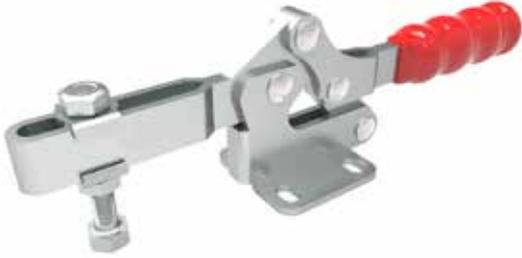
**Bloccaggio orizzontale, base piatta, portata 150 kg**, Bloccaggio: orizzontale; Base: piatta flangiata; Braccio: regolabile; Materiale: acciaio; Impugnatura: poliuretano rosso, resistente a oli, grassi, agenti chimici; Peso: 220 gr.
