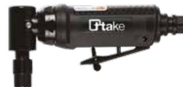
Smerigliatrice pneumatica angolare – 6 mm. Velocità libera: 20.000 giri/min. Attacco quadro: 6 mm / 3 mm. Attacco aria: 1/4" NPT. Ø interno tubo: 10 mm. Consumo aria: 113 l/min. Lunghezza: 165 mm. Peso: 0,5 kg. Potenza: 0,2 Kw. Rumorosità: 84 dBA. Pressione aria raccomandata: 6,2 bar.
