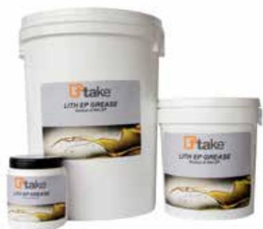
**LITH EP GREASE grasso al litio E.P., grasso di qualità superiore, dall'aspetto pomatoso / semifiante, di colore chiaro.** Additivato E.P. (Estreme Pressioni), è dotato di **eccellente stabilità meccanica, ottima resistenza all'ossidazione, all'invecchiamento ed all'azione dilavante dell'acqua,** è utilizzabile in un ampio intervallo di esercizio (da -20°C a +120°C). Consistenza NLGI 2.
