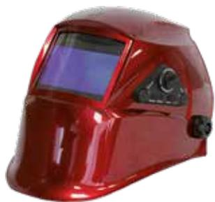
**WELD MASK**, Maschera professionale di protezione per saldatura, con display a cristalli liquidi LCD. 4 sensori di luce. Sensibilità e tempo di ritardo regolabili. **Oscurezza variabile:** DIN 4/5-8/9-13. **Tempo di ritorno al chiaro:** 0.1-1.0 s. **Superficie di visione:** 100x60 mm. **Classe CE:** 1/1/1/1. **Protezione:** UV/IR. **Peso:** 425 gr.
