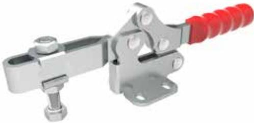
**Bloccaggio orizzontale, base piatta, portata 250 kg**, Bloccaggio: orizzontale; Base: piatta flangiata; Braccio: regolabile; Materiale: acciaio; Impugnatura: poliuretano rosso, resistente a oli, grassi, agenti chimici; Peso: 430 gr.
