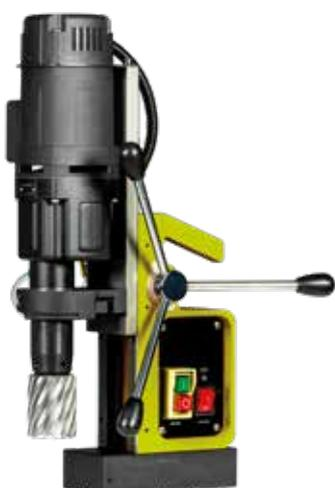
**Trapano a supporto magnetico 50mm**, per uso professionale. Specifico per realizzare fori su metalli fino a Ø 50 mm, con frese attacco Weldon 19 mm. Dotato di sistema refrigerante integrato. Massima escursione di lavoro: 170 mm. Capacità massima foratura: 50 mm. Profondità di foratura: 50 mm. Svasatura: 10-50 mm. Adesione magnetica: 16.000 N. Dimensioni elettromagnete: 49x168x84 mm. Possibilità di utilizzo a 2 velocità.
