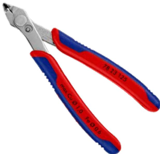
**Electronic Super Knips®.** Tronchese particolarmente adatto per il taglio di alta precisione nell'elettronica e nella meccanica fine. Taglienti rettificati di precisione senza sfaccettatura, adatti anche per tagliare fili metallici poco sporgenti da Ø 0,2 mm. Sezione di taglio con micro-spostamento dei taglienti controllato per un taglio ultrapreciso. Con molla di ritorno e delimitazione di apertura Durezza dei taglienti 54 HRC. Manici rivestiti in materiale bicomponente.
