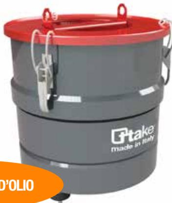
**MIST FILTER 500**, aspiratore industriale per nebbie d'olio, ideale per l'aspirazione degli inquinanti di qualsiasi tipo di macchina utensile. Facile installazione direttamente sulla cabina della macchina utensile. Fornito con post-filtro certificato H13 che consente un elevatissimo livello di filtrazione finale (99,97%). Portata aria: 500 mc/h; potenza: 0,18 kW; rumorosità 62 db; superficie filtrante: 2.300/20.000 cm<sup>2</sup>.
