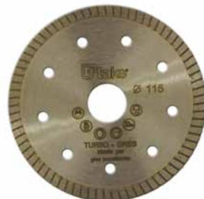
**TURBO-GRES**, disco diamantato con corona continua (7mm di altezza). Raccomandato per il taglio specifico di **ceramica, piastrelle in gres porcellanato e in klinker**. Ø foro 22,2 mm; spessore 1,2mm.
