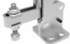
**Bloccaggio verticale, base piatta, portata 150 kg,** Bloccaggio: verticale; Base: piatta flangiata; Braccio: regolabile; Materiale: acciaio; Impugnatura: poliuretano rosso, resistente a oli, grassi, agenti chimici; Peso: 240 gr.
