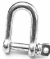
Grillo diritto zincato, certificato CE; DIN 82101; tipo A; in acciaio al carbonio, con zincatura elettrolitica; coefficiente di sicurezza 5.
