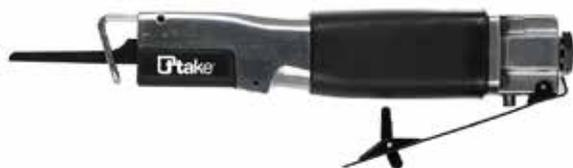
Seghetto pneumatico. Corsa al minuto: 9.000. Corsa: 10 mm. Attacco aria: 1/4" NPT. Ø interno tubo aria: 10 mm. Consumo aria: 113 l/min. Lunghezza: 235 mm. Peso: 0,5 kg.
