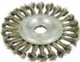
**Spazzole circolari a mazzetti ritorti**, aggressive, ideali per applicazioni gravose su cordoni di saldatura, per la sbavatura ed il decapaggio meccanico. Foro 22mm; filo 0,5; un rango.
