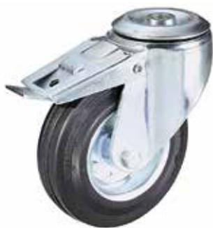
Ruota con nucleo in lamiera stampata e zincata, con supporto rotante a foro passante e freno totale anteriore; anello in gomma piena nera a profilo trapezoidale; gruppo rotante realizzato con doppia corona di sfere. Codolo non incluso.
