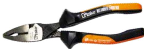
Pinza universale con molla, manici ergonomici, testa pulita, taglienti durezza 64 HRC, per il taglio di fili metallici a bassa ed alta resistenza, becchi con 4 punti di contatto per una presa sicura, taglienti allungati per tagli precisi, DIN ISO 5746, per impieghi gravosi e prolungati; disponibile nelle versioni con manici rivestiti in materiale bicomponente e con manici rivestiti in resina sintetica.
