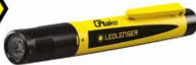
**Torcia tascabile da ispezione, a led, con certificazione ATEX zona EX 0/20.** Resistente ad acqua e polvere (IP66), idonea ai gruppi gas e polveri a più alto rischio (IIC/IIIC), idonea all'utilizzo in presenza di polveri non conduttive e conduttive, utilizzabile fino alla classe di temperatura T4 per i gas e T135°C per le polveri. Alimentazione: 2xAAA alcalina.
