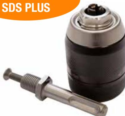
Kit mandrino portapunte automatico in metallo con adattatore SDS Plus, per utilizzo in avvvitamento e percussione, griffe in metallo duro, con sistema di chiusura *lock system*.
