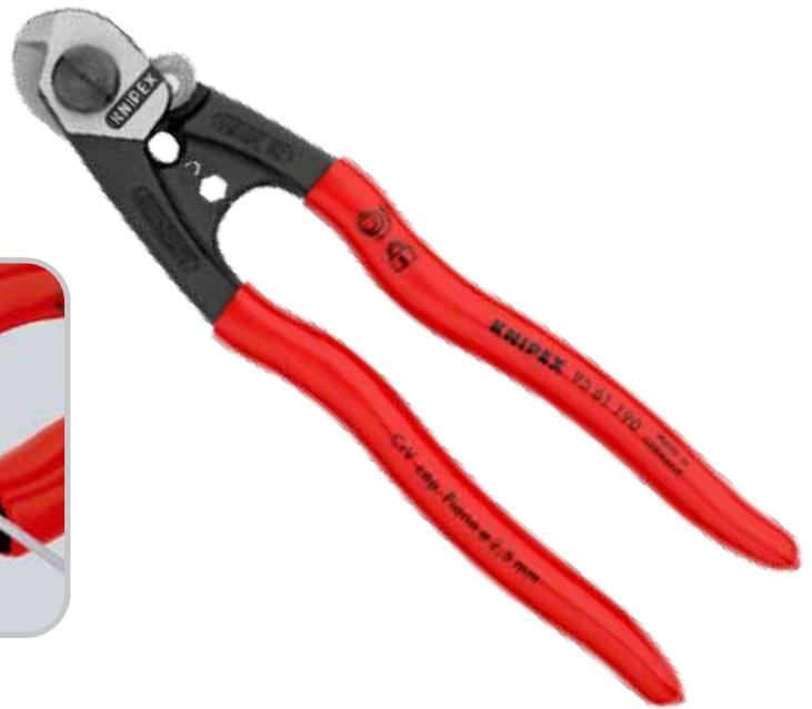
**Cesoia per funi in acciaio.** Forgiata, con due profili di crimpaggio per cappucci dei cavi Bowden e terminali di funi metalliche. Articolazione a vite per una guida precisa della lama, regolabile. Durezza dei taglienti 64 HRC. Manici rivestiti in resina sintetica.
