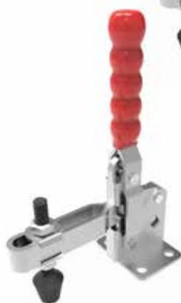
**Bloccaggio verticale, base piatta, portata 350 kg,** Bloccaggio: verticale; Base: piatta flangiata; Braccio: regolabile; Materiale: acciaio; Impugnatura: poliuretano rosso, resistente a oli, grassi, agenti chimici; Peso: 635 gr.
