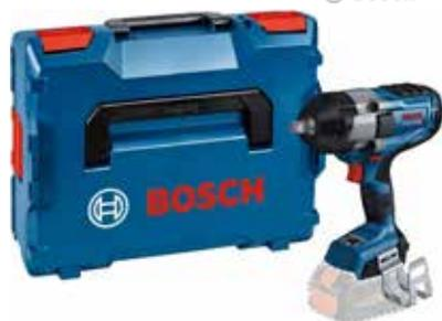
**GDS 18V-1000 C PROFESSIONAL Avvitatore a massa battente a batteria.** Potente avvitatore a percussione con batteria da 1/2" al Litio con modalità impostabili e tecnologia BITURBO Brushless per una coppia di serraggio da 1000 Nm e una coppia di distacco da 1600 Nm. Interfaccia di comando con due modalità predefinite: Metallo (A) e Legno (B). Tre impostazioni di numero di giri e coppia.
