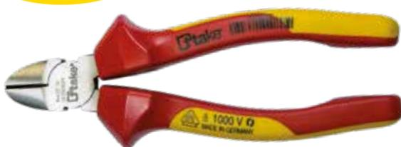
Tronchese laterale per meccanica, manici ergonomici, rivestiti in materiale bicomponente isolati a 1000 Volt, collaudati VDE, taglienti durezza 62 HRC, DIN ISO 5749, per impiego universale.
