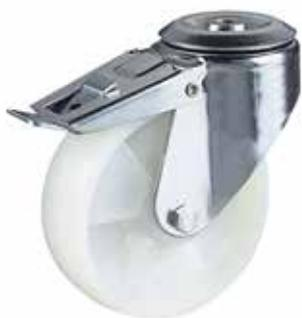
Ruota monolitica in poliammide, con supporto rotante a foro passante in lamiera stampata e zincata e freno totale anteriore; gruppo rotante realizzato con doppia corona di sfere. Dado autobloccante al mozzo. Codolo non incluso.
