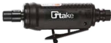
Smerigliatrice pneumatica dritta – 6 mm. Velocità libera: 25.000 giri/min. Attacco quadro: 6 mm / 3 mm. Attacco aria: 1/4" NPT. Ø interno tubo: 10 mm. Consumo aria: 113 l/min. Lunghezza: 161 mm. Peso: 0,4 kg. Potenza: 0,2 Kw. Rumorosità: 84 dBA. Pressione aria raccomandata: 6,2 bar.
