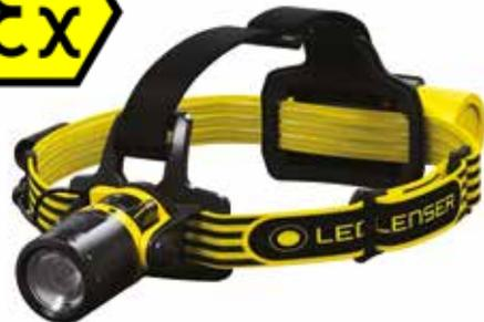
**Torcia frontale da ispezione, a led, con certificazione ATEX zona EX 0/20, con Magnetic Switch** per un semplice utilizzo con guanti e protezioni. Resistente ad acqua e polvere (IP66), idonea ai gruppi gas e polveri a più alto rischio (IIC/IIIC), idonea all'utilizzo in presenza di polveri non conduttive e conduttive, utilizzabile fino alla classe di temperatura T4 per i gas e T135°C per le polveri. Luce posteriore di posizione. Alimentazione: 3xAA alcalina.
