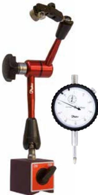
Kit supporto magnetico snodato porta comparatore (forza trazione 80 kg, raggio d'azione 340 mm), completo di comparatore di precisione (Ø 58 mm, corsa 10 mm, risoluzione 0,01, scala circolare 0÷50÷100).
