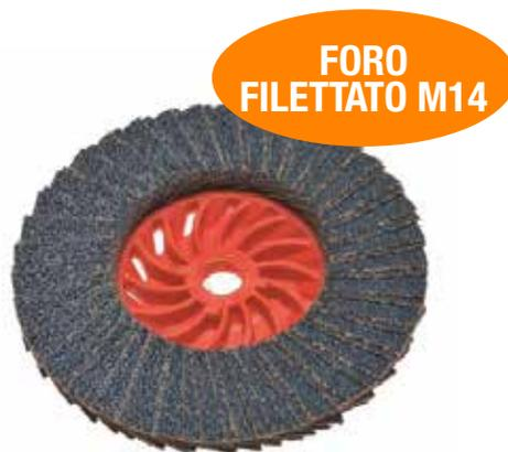
Disco lamellare piano, AB5500, a doppia lamella con supporto in nylon rinforzato con bordi esterni scanalati; foro filettato M14; supporto con intagli e profilo a turbina per una maggiore circolazione dell'aria e minor surriscaldamento della smerigliatrice e del pezzo lavorato. Dimensioni: 115xM14; confezioni da 20 pz.
