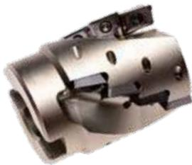
Fresa a riccio a 90° TA9011 con attacco a manicotto, con fori di refrigerazione; adatta all'utilizzo di inserti APKT 1003...
