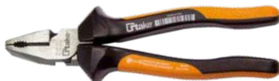
Pinza universale per filo armonico, manici ergonomici rivestiti in materiale bicomponente, testa pulita, taglienti durezza 64 HRC, per il taglio di fili metallici a bassa resistenza e filo armonico, taglienti di precisione extra lunghi, con sfaccettatura per un migliore accesso, DIN ISO 5746, per impiego universale.
