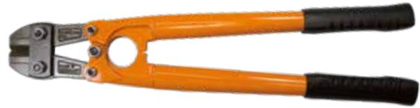
**Troncabulloni**, testa intercambiabile bonderizzata nera, manici a leva con angolazione ergonomica in acciaio tubolare, capacità di taglio fino a durezza 44 HRC, durezza taglienti 62 HRC, impugnature robuste e maneggevoli, lama in acciaio al cromo vanadio ad alte prestazioni, DIN ISO 5743.
