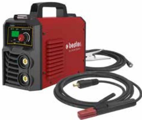
**155-ND.** Saldatrice ad inverter Stick e Lift TIG. 230V/1Ph. Corrente di uscita: 140 A@15%. Ciclo di lavoro nominale a 40°C. Portatile, leggera e facile da maneggiare. Display digitale. Ideale per elettrodi rutili e basici. Fornita con porta elettrodi e cavo massa (3 m).
