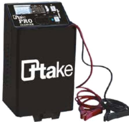
**PRO CHARGER**, caricabatterie semiprofessionale 12/24V, con tre regolazioni, ideale per la carica di batterie da 75/300 Ah, ed avviatore per uso non professionale. **Potenza assorbita:** 1,1KW (carica) – 6,2 KW (avviamento). **Corrente effettiva 24V:** 47A (carica) – 250A (avviamento). **Corrente effettiva 12V:** 63A (carica) – 285A (avviamento). **Dimensioni:** 320x215x620 mm. **Peso:** 18 kg
