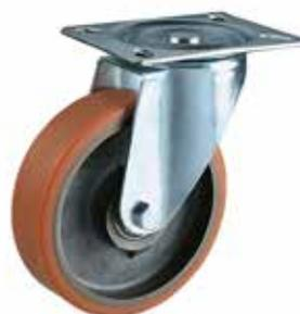
Ruota con nucleo in ghisa, con supporto rotante a piastra in lamiera stampata e zincata, serie media, rivestimento in poliuretano colato con durezza 92 ± 2 Shore A; gruppo rotante realizzato con doppia corona di sfere. Dado autobloccante al mozzo. Mozzo con cuscinetti a sfere.
