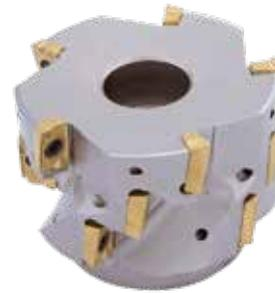
Fresa per spianature a 75° TA7516 con attacco a manicotto, con fori di refrigerazione; adatta al recupero dei due taglienti non utilizzati degli inserti APKT 1604...
