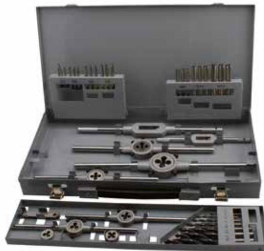
Set maschi e filiere TA1670, Set in cassetta metallica composti da: una serie di 3 pz. di maschi a mano e una filiera (da M3 a M12 - da M3 a M20). Completati di 2 giramaschi, 5/6 portafiliera, 1 contafiletti, 7 punte per prefiori d.2,5-3,3-4,2-5-6,8-8,5-10,2 e un giravite.
