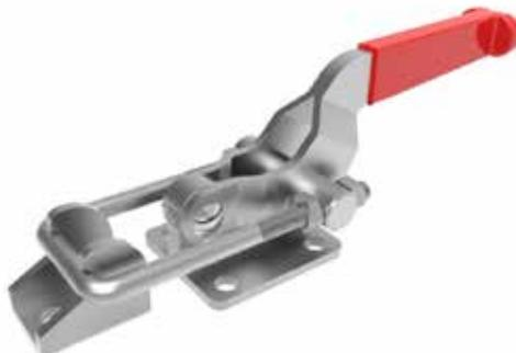
**Bloccaggio a tirante, base piatta, portata 920 kg**, Bloccaggio: a tirante; Base: piatta flangiata; Braccio: regolabile; Versione: orizzontale; Materiale: acciaio; Impugnatura: poliuretano rosso, resistente a oli, grassi, agenti chimici; Peso: 680 gr.
