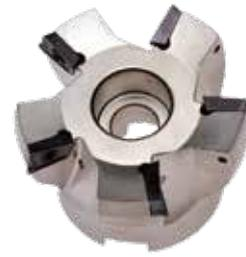
Fresa per spianature a 75° TA7510 con attacco a manicotto, con fori di refrigerazione; adatta al recupero dei due taglienti non utilizzati degli inserti APKT 1003...
