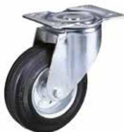
Ruota con nucleo in lamiera stampata e zincata, con supporto rotante a piastra; anello in gomma piena nera a profilo trapezoidale; gruppo rotante realizzato con doppia corona di sfere. Codolo non incluso.
