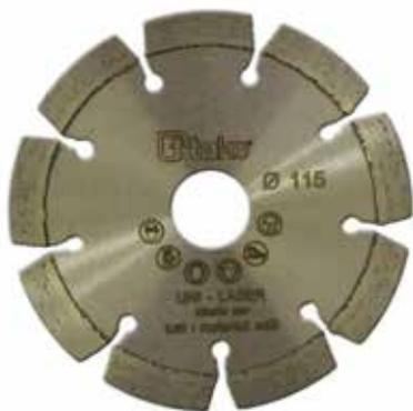
**UNI-LASER**, disco diamantato con corona continua (10mm di altezza) a settori, per il taglio **universale**. Settori saldati laser per la massima sicurezza. Garantisce **eccellenti prestazioni e rapidità di taglio**. Utilizzabile su tutti i materiali edili duri; particolarmente raccomandato per calcestruzzo, anche armato.
