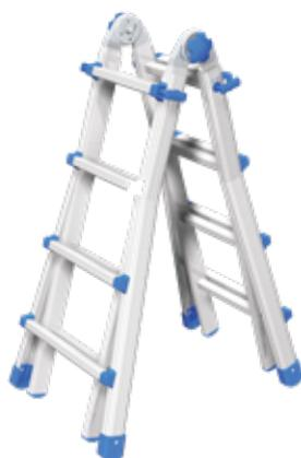
**Scala telescopica multiuso UNIVERSALE EN 131.** Scala telescopica in alluminio, utilizzabile a cavalletto, zoppa, doppia e allungata, per un utilizzo professionale intensivo. Passo tra i pioli: 280mm. Pioli zigrinati antidrucciolo. Cerniere a posizionamento rapido. Ganci di blocco in acciaio ricoperti in nylon. Tacchi ergonomici antidrucciolo. Impugnatura cerniera in acciaio zincato con 3 perni in acciaio (BREVETTATA). Numero pioli: da 6 a 24.
