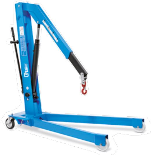
**Gru idrauliche a carrello pieghevoli:** stelo rettificato e cromato; braccio allungabile in quattro posizioni; ruote posteriori girevoli; gancio girevole a 360°; pompa idraulica a due velocità; comando discesa a velocità controllata.
