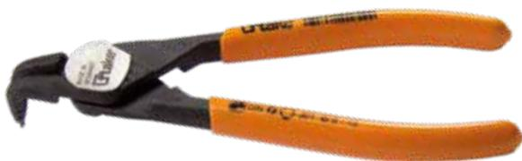
Pinza per anelli di sicurezza interni, con becchi piegati a 90°, manici rivestiti in resina sintetica (pvc), testa bonderizzata nera, per il montaggio di anelli di sicurezza interni (DIN 471 e DIN 983) per fori da Ø 8 – 140mm, punte piegate a 90° resistenti antiscivolo, DIN ISO 5256 D.
