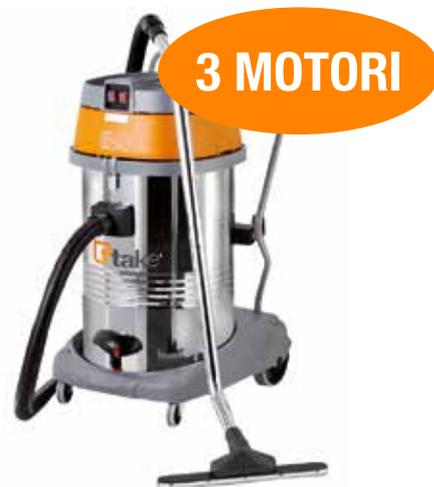
**WETTY 803 B:** Aspiratore solidi-liquidi carrellato, di grandi prestazioni, dotato di serbatoio in acciaio inox e kit antistatico, ha la possibilità di utilizzare accessori da Ø 40 per portate elevate, possibilità di utilizzare un singolo motore, due o tre contemporaneamente, involucro con capacità di basculamento e con gancio di bloccaggio; capacità serbatoio 80 lt; potenza max 3450 W; portata aria 150 lt/s; 3 motori; peso 26 kg; dimensioni 610 x 520 x 920 mm.
