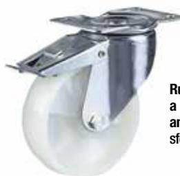
Ruota monolitica in poliammide, con supporto rotante a piastra in lamiera stampata e zincata e freno totale anteriore; gruppo rotante realizzato con doppia corona di sfere. Dado autobloccante al mozzo. Codolo non incluso.
