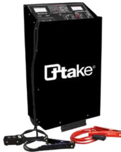
**PRO CHARGER 1000**, caricabatteria professionale 1 PH 12/24V, ideale per batterie da 160/180 Ah ed avviatore professionale con telecomando. Con 8 regolazioni di carica. **Potenza assorbita:** 2,7 kW (carica) – 12 kW (avviamento). **Corrente effettiva 12V:** 88A (carica) – 600A (avviamento). **Corrente effettiva 24V:** 90A (carica) – 570A (avviamento). **Dimensioni:** 450x300x835 mm. **Peso:** 33 kg.
